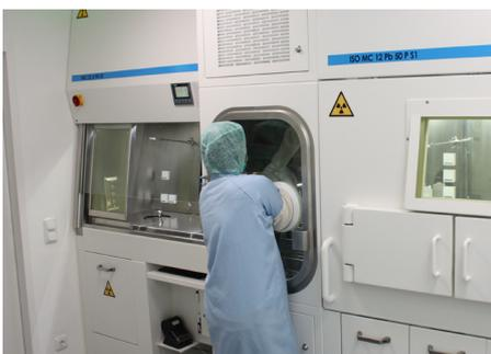
Das Herzstück, der neue Isolator: Hier werden die neuen Gallium-Radiopharmaka hergestellt. Die Luft darin ist so sauber, dass die Mitarbeiterin die Grundstoffe für die Herstellung nur indirekt über eine Vorkammer (Mitte) einschleusen darf.
